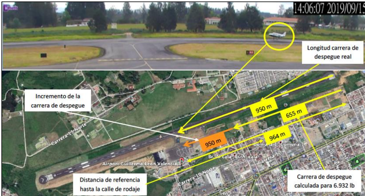
Fotografía No. 30: Carrera de despegue de la aeronave vs. la calculada en Manual de Operación.
