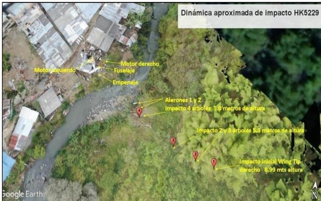
Gráfica No. 6: Secuencia de impacto y ubicación de componentes de la aeronave.
