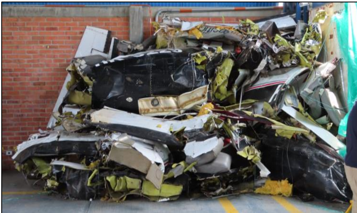
Fotografía No. 7: Restos de la aeronave almacenados para el procedimiento de reconstrucción.
