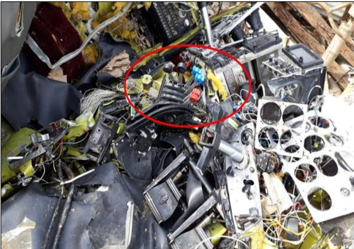
Fotografía No. 6: Pedestal de controles de los motores.
