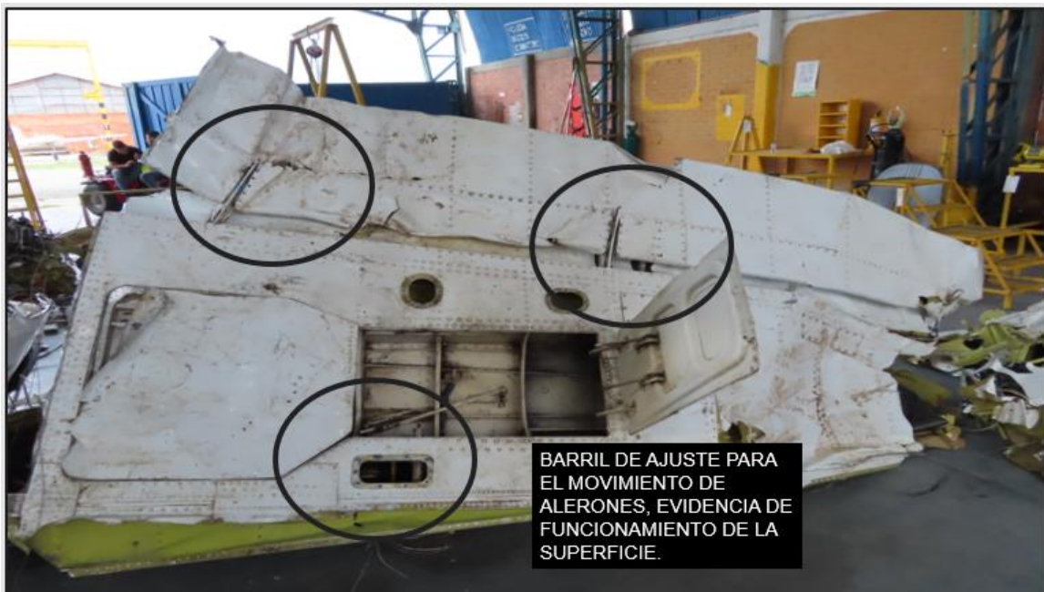
Fotografía No. 14: Análisis de funcionamiento para las superficies de control.
