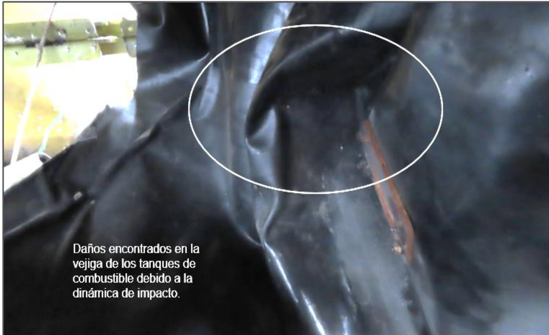
Fotografía No. 13: Daños encontrados en los tanques de combustible.
