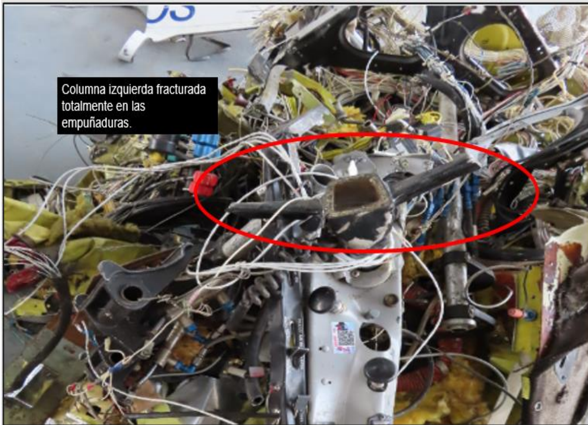
Fotografía No. 10: Columna izquierda de mando fracturada.
