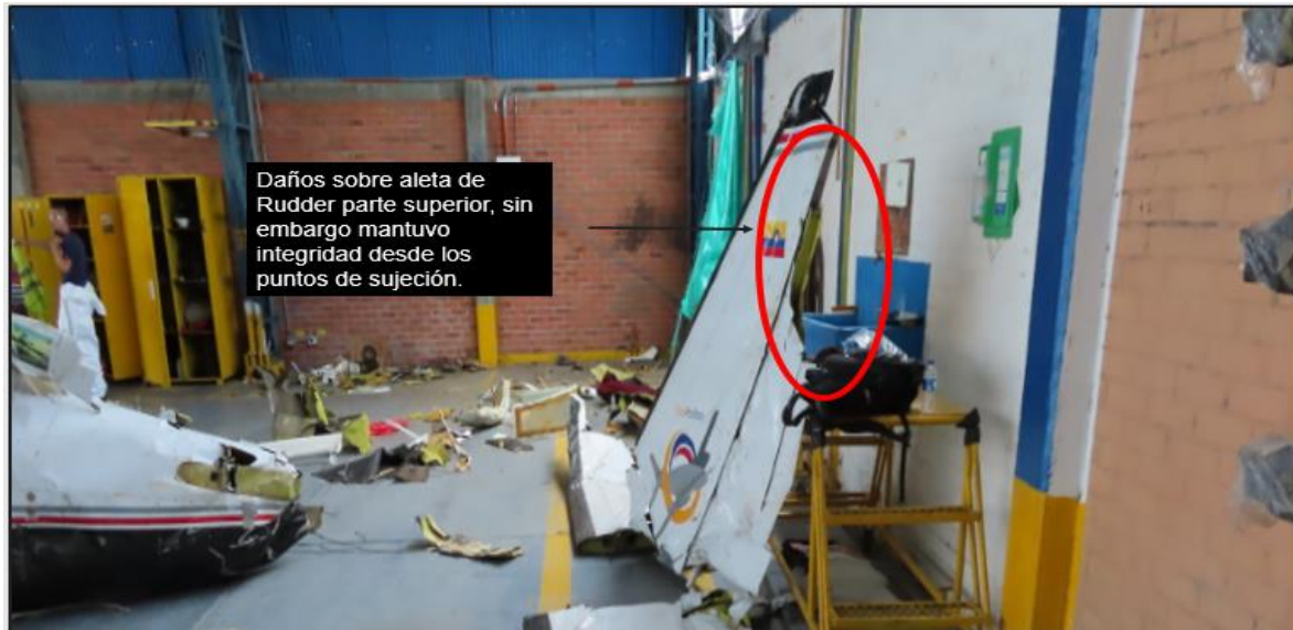
Fotografía No. 16: Daños encontrados sobre el estabilizador vertical a consecuencia del impacto.
